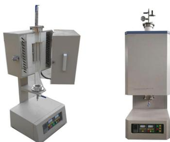
В зависимости от температуры, трубка печи может быть изготовлена из кварца или глинозема высокой чистоты и снабжена фланцем с вакуумным уплотнением. Печь может быстро нагревать или охлаждать образцы в условиях вакуума или потока инертного газа. Это идеальная печь для испытаний на охлаждение образцов и измерения температуры.
