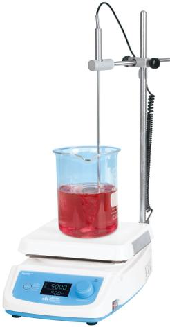
Магнитные мешалки с подогревом MaXtir MSH500 предназначены для перемешивания и нагрева жидкостей объемом до 20 литров. Максимальная регулируемая температура нагрева – 500 °С. Регулирование температуры производится с высокой точностью - погрешность регулирования температуры не более  $\pm 0,3$  °С. Платформа прибора изготовлена из стеклокерамики, стойкой к химическому и тепловому воздействию.
