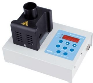
Приборы для определения точки плавления MP360D позволяют определять точку плавления одновременно для 2 образцов. Исследования проводятся в закрытых и открытых капиллярах. Диапазон регулирования температуры нагрева образца - от комнатной до 300 °С.
