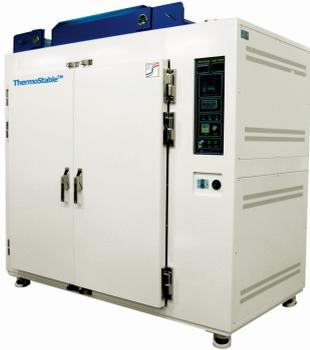
Промышленные сушильные шкафы с принудительной циркуляцией серии ThermoStable WOF предназначены для сушки электронных и полупроводниковых компонентов. Необходимая температура рабочей камеры контролируется и поддерживается цифровой системой с ПИД-регулированием. Безопасность работы обеспечивается встроенными системами защиты от перегрева и контроля сети электропитания (встроенные вольтметр и амперметр).
