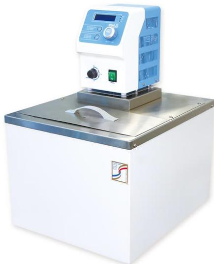
**Применение:** Циркуляционная ванна с нагревом MaXircu CH-12 предназначена для подачи подогретого теплоносителя в различные приборы и системы с целью поддержания во времени заданной температуры в замкнутом контуре в диапазоне от комн. +5 °С до 250 °С. Преимущественно используются в химических или физических лабораториях и небольших высокотехнологичных производствах. Ускорение протекания химических процессов за счет нагрева в органическом синтезе за счет циркуляции теплоносителя.
