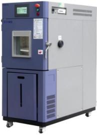
Испытательные климатические камеры позволяют имитировать агрессивное воздействие окружающей среды: высокие или низкие температуры воздуха, уровень влажности. Устройства этого типа обеспечивают во внутреннем объеме длительное поддержание температуры в диапазоне от 20 до 100 градусов Цельсия и уровень влажности от естественного до 98%. Основное назначение этих приборов – испытания различных материалов и изделий в статичном режиме.
