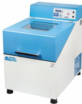
Шейкеры-инкубаторы ThermoStable IS-20 предназначены для равномерного распределения веществ в лабораторных сосудах в процессе инкубации. Максимальная температура инкубации - +60 °С. Необходимая температура рабочей камеры контролируется и поддерживается микропроцессорной системой. Доступны к заказу модели с системой охлаждения и без неё.
