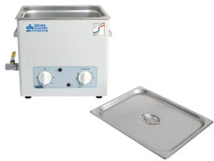
Аналоговый ультразвуковой очиститель "WUC-A" изготовлен из нержавеющей стали. Принцип работы основан на создании колебательных движений жидкости в камере, за счет чего обеспечивается отчистка погруженных деталей. Предназначен для очистки объектов (колбы, пробирки, механические части двигателей, моторов, любых небольших металлических и пластиковых объектов) от механических загрязнений и удаление пузырьков воздуха из жидкости за счет применения ультразвука.
