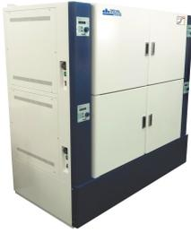
Многокамерный инкубатор "WIM" с принудительной конвекцией воздуха. Имеет 4 камеры, каждая объемом 125 литров. Корпус выполнен из стали с порошковым покрытием, в комплекте 8 стальных полок с полиэтиленовым покрытием. Прибор подходит для выращивания микроорганизмов и клеточных культур, выдерживания проб в стабильных температурных режимах и других целей. Используется в лабораторных и промышленных целях, в области медицины, биологии и химии.
