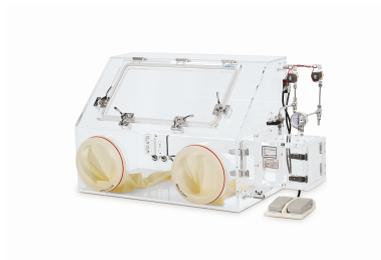
Перчаточный бокс из полиметилметакрилата GloV.800P с перчатками из натурального каучука и камерой для переноса. Бокс предназначен для создания чистой рабочей зоны без примесей кислорода в вакууме для проведения химических реакций или каких-либо манипуляций в микроэлектронике в особых условиях, для которых требуется отсутствие кислорода и влаги.
