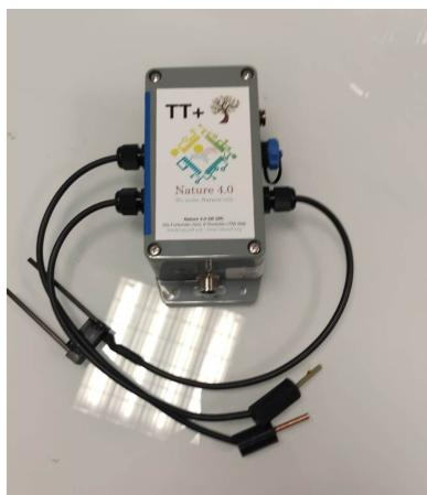
Датчик, предназначенный для регистрации следующих параметров: изменение угла наклона дерева; относительная влажность воздуха; температура воздуха; сокодвижение в дереве; прирост диаметра ствола дерева; светопропускание листвы
