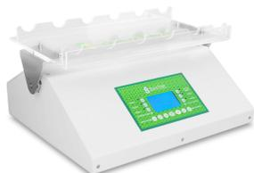
Прибор для определения седиментации ZELENY 3100 методом Зелени, применяется для определения объёма осадка, появившегося в определённых условиях из пульпы, анализируемой цельно смолотой муки в растворе молочной кислоты, в присутствии бромфенолового синего. Показатель седиментации показывает степень зараженности зерна клопом-черепашкой.
