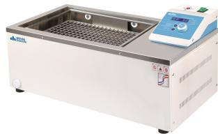
Бани-шейкеры серии MaXturdy предназначены для перемешивания образцов бактериальных и клеточных культур, лабораторных исследований в областях биотехнологии, молекулярной биологии и др. Регулирования температуры бани производится с высокой точностью - погрешность регулирования температуры не более  $\pm 0,1$  °С. Диапазон регулирования температуры - от комнатной температуры +5°С до 100°С. В комплект поставки входит универсальный держатель для колб и пробирок.
