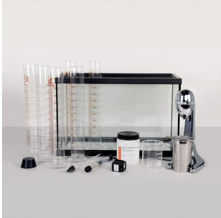
Тестовый набор гидрометра используется для определения распределения частиц по размерам очень мелких материалов, таких как ил и глина.
