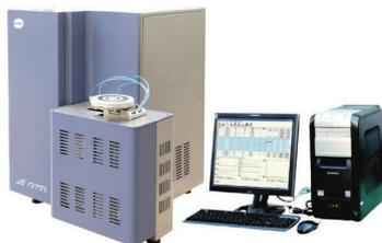
Элементный анализатор YX-CHN5000 предназначен для определения элементного состава образца (содержания углерода, водорода и азота). Широко применяется в экологических и агрохимических лабораториях. Углерод может быть определен как в неорганической, так и в органической формах с помощью предварительной кислотной обработки или измерения разности температур.
